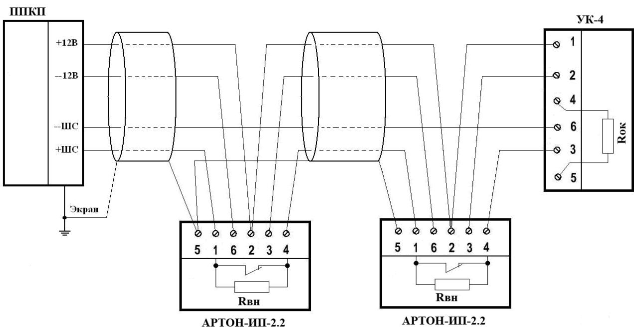
**R<sub>ок</sub>** – оконечный резистор, устанавливается согласно требований эксплуатационной документации на ППКП.
