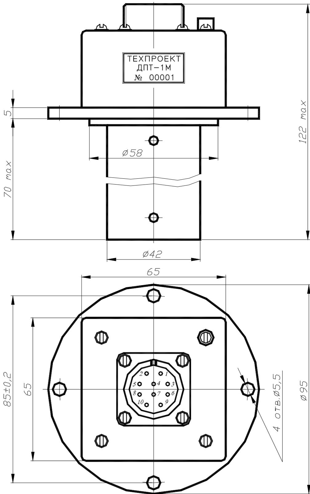
Рисунок 2 - Габаритные размеры ДПТ-1М.
